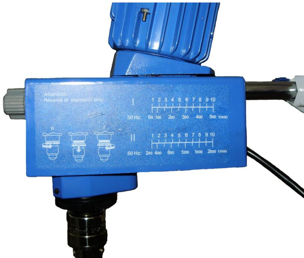
Зажимной патрон и вращательный вал служат для фиксации стержня перемешивающей насадки с диаметром до 10 мм. Отверстие в верхней части блока двигателя позволяет продвинуть стержень перемешивающей насадки вверх для удобства смены посуды с рабочей сусpenзией. Эта процедура должна осуществляться только в выключенном состоянии прибора.
