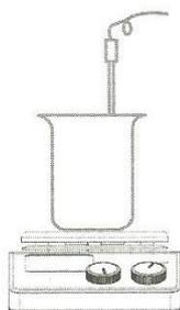
Если внешний температурный датчик не подключен, символ “Probe” будет мигать на дисплее. Если датчик подключен, символ “Probe” будет указываться на дисплее, что означает, что датчик используется. Значения внешнего температурного датчика и фактическая температура указываются на дисплее.
